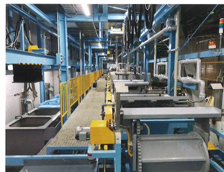
キャリヤ式めっき装置 Carrier type
